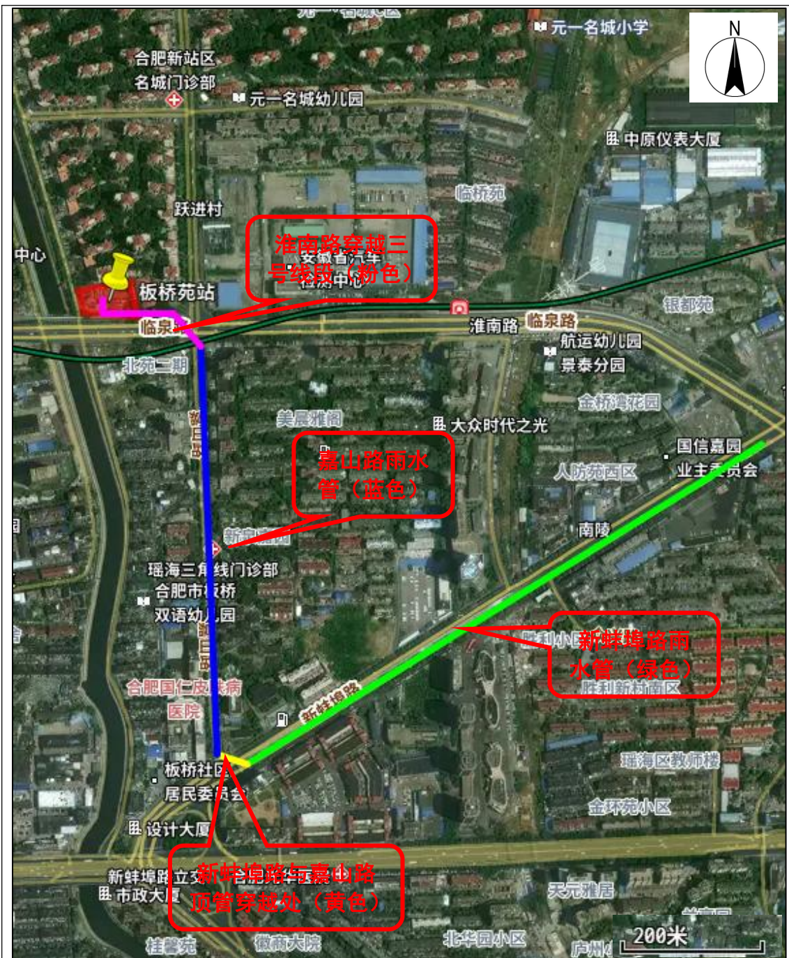
图 4-1 雨水管网改造工程路线图
